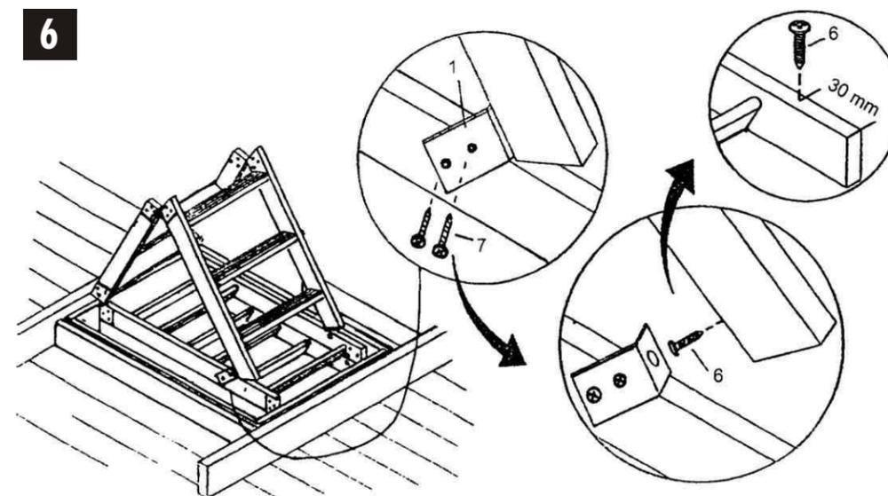
Schody složte do stropní konstrukce a do pravé bočnice posledního dílu sklopného mechanismu zašroubujte asi 30 mm od okraje polohový vrut  $\varnothing$  4x25 a nedotahujte. Hlavu vrutu zaklesněte do otvoru v plechovém "L" profilu, který připevněte pomocí vrutů  $\varnothing$  4x16 na druhý díl do takové polohy, aby čtvrtý díl nepřesahoval obrys složeného sklopného mechanismu schodů a spolu s třetím dílem tvořil tvar písmene "A".
