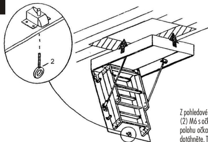
Z pohledové strany sklápěcích dveří našroubujte skrz dveře do zámku háček (2) M6 s očkem - nedotahujte. Polohu očka natočte do osy schodů. Zajistěte polohu očka, na vyčnívající závitovou část našroubujte matici M6 a pevně dotáhněte. Tím je zajištěna poloha háčku proti otevření. (obr. 2)
