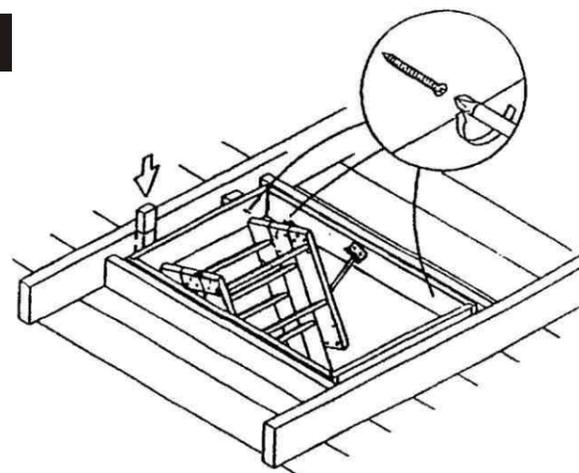
Smontovaný celek vyzvedněte do předem připraveného stavebního otvoru a zajistěte osmi vruty (nejlépe 8x60 mm), které zašroubujte skrz průlez schodů do nosníků stropní konstrukce. (obr. 3)
