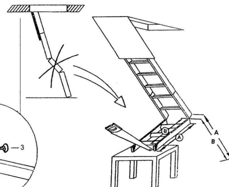
Otevřete sklápěcí dveře až do polohy dorazu na závěrném ústrojí, rozložte sklopný mechanismus schodů a připevněte čtvrtý (spodní) díl pomocí vratových šroubů M6x30, podložek a matic M6. Tento díl podrhněte, doměřte rozdíl mezi spodním koncem třetího dílu sklopného mechanismu a podlahou ve směru sklonu schodů. Přeneste délku (A, B) na čtvrtý díl sklopného mechanismu a zařízněte (obr. 4 a 5).
